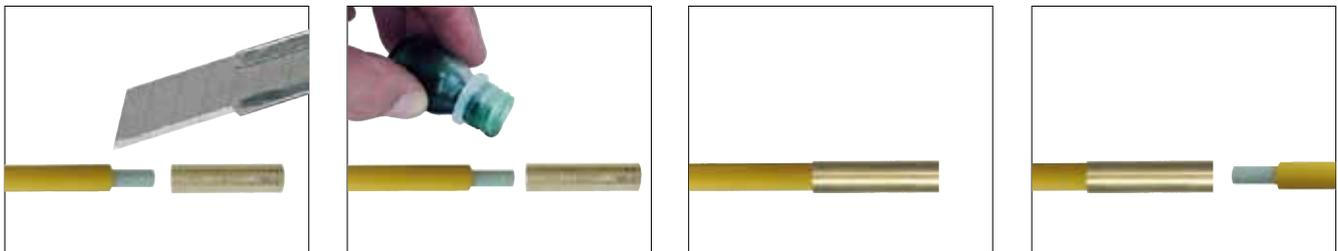
Riparazione di una sonda con rottura centrale usando gli art. **AGS9 e AGS11**
