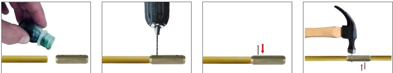
Riparazione di una sonda con rottura terminale usando gli art. **AST35, AST45, AST6**
