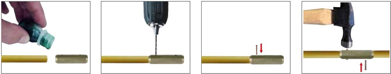
Riparazione di una sonda con rottura centrale usando gli art. **ASR9 e ASR11**
